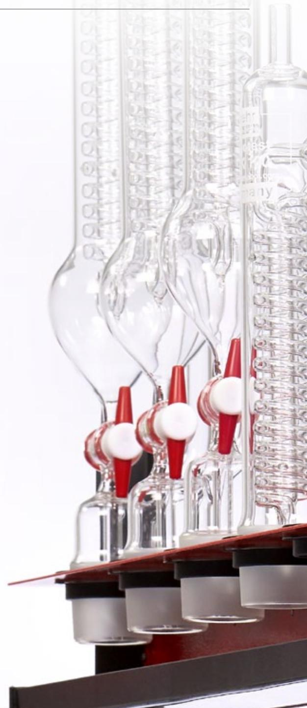
Die Extraktion nach Twisselmann ist eine kontinuierliche Heißextraktion. Sie funktioniert ähnlich wie die Soxhlet-Extraktion. Allerdings ist die Temperatur im Twisselmann-Extraktor in der Probe sehr heiß, d.h. nah am Siedepunkt des Lösungsmittels. Das verbessert die Löslichkeit und verkürzt die Extraktionszeit.
